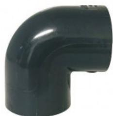
Coude égal à 90° PVC à coller femelle femelle Ø20 adapté pour le raccordement à l'équerre des canalisations en PVC pression (maxi 16 bar) de même diamètre.
